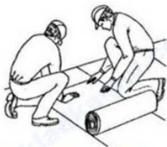
Укладка Напольных Покровтий
